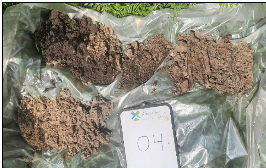
Figuur 7. Foto van boring 4. De leesrichting is van linksboven naar rechtsonder (0 – 150 centimeter) (Foto: 4 juni 2024).
