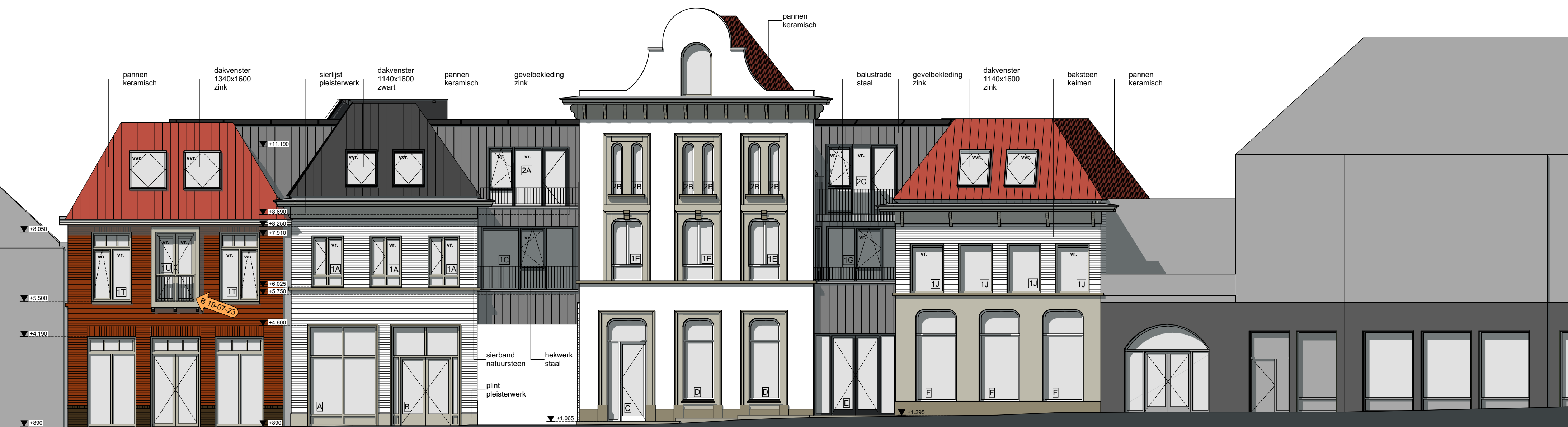
VOORGEVEL - ZANDSTRAAT vr = zelfregulerend ventilatierooster vvr = zelfregulerende ventilatieunit Velux dakvenster
