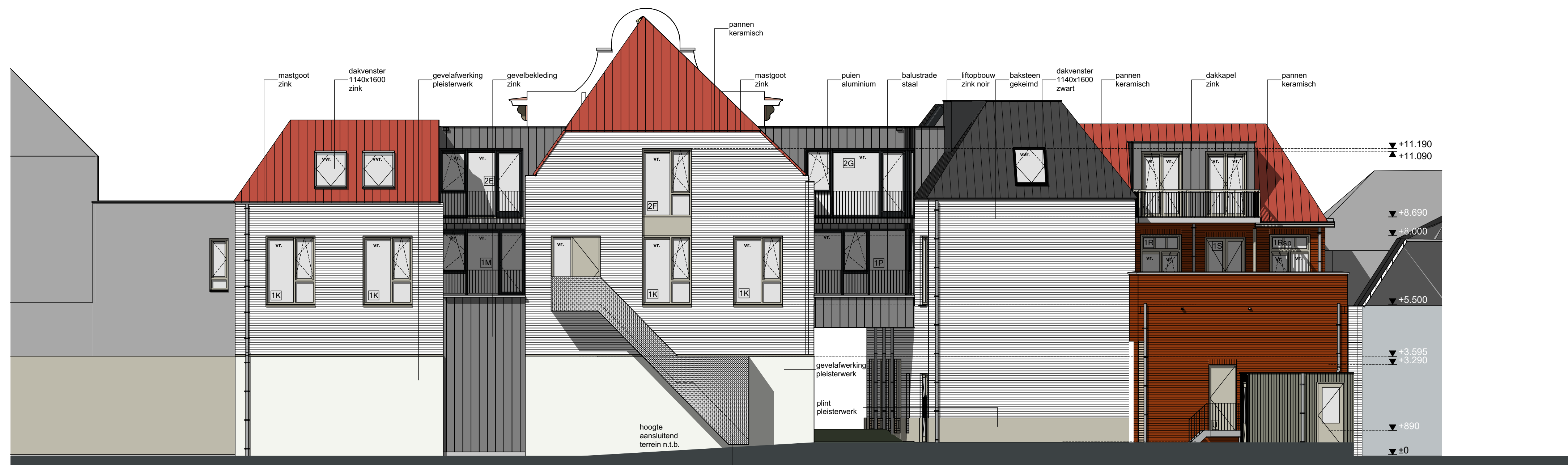
ACHTERGEVEL DE POEL vr = zelfregulerend ventilatierooster vvr = zelfregulerende ventilatieunit Velux dakvenster
