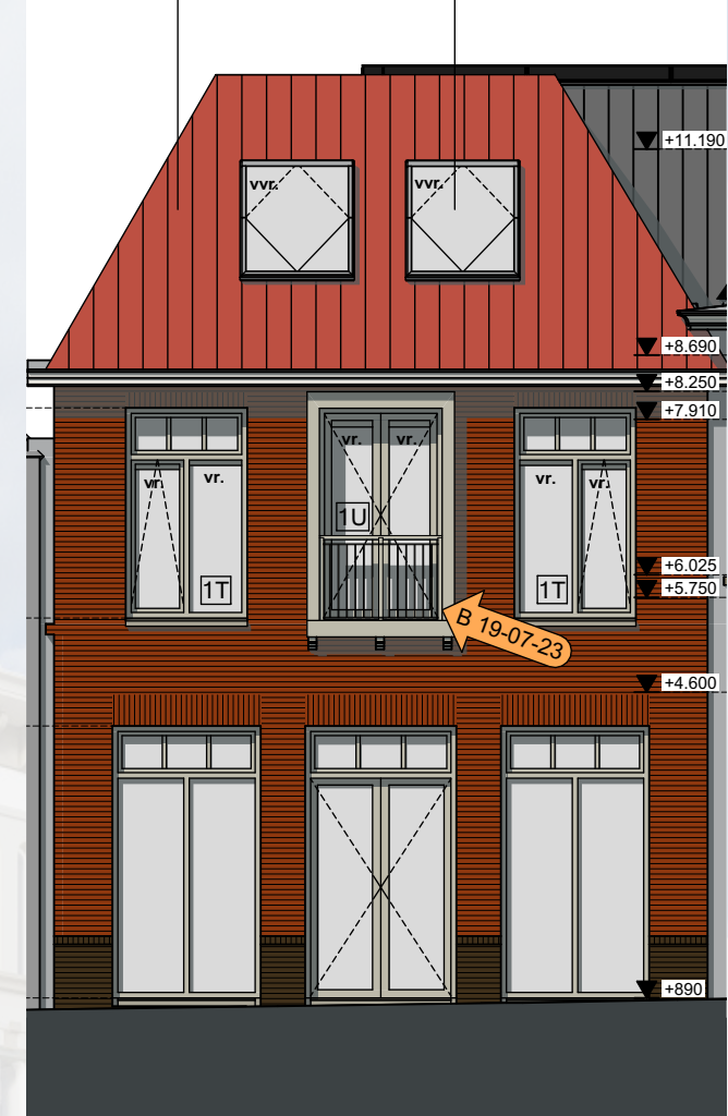
goot en kozijnen Herfst en Helder 1610 of RAL 7032 Frans balkon is binnen het kader geplaatst (advies dd.09-08-'22 punt 7-2)
