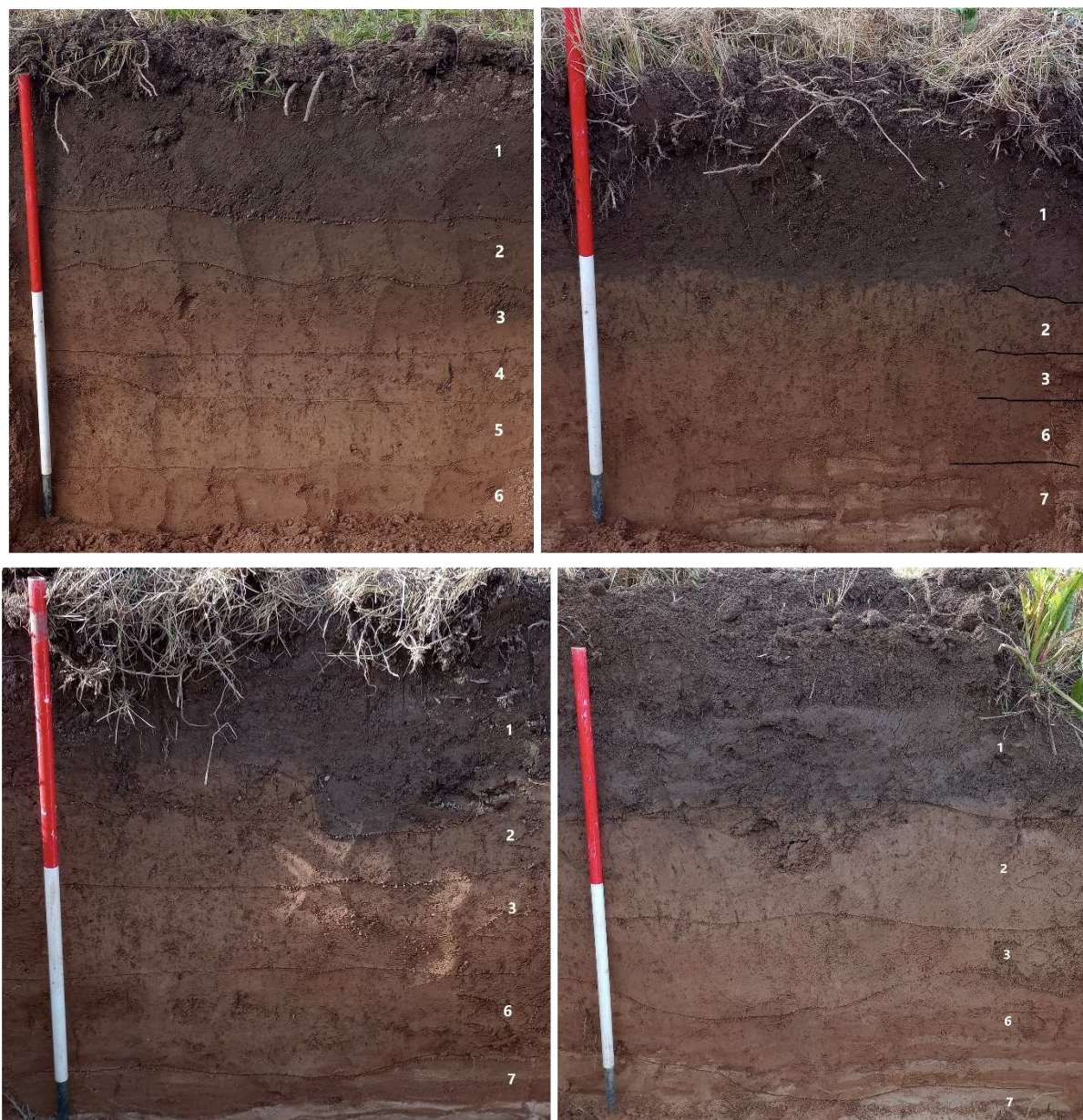
Figuur 6. Linksboven: profiel 241. Rechtsboven: profiel 541. Linksonder: profiel 1642. Rechtsonder: profiel 1942. 1=bouwvoor; 2=AB-horizont; 3=B-horizont; 4, 5=Bt-horizont; 6=BC-horizont; 7=C-horizont.
