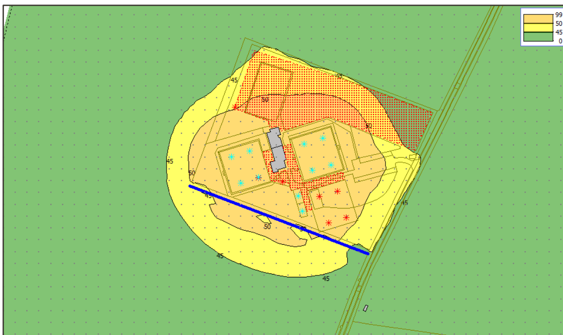
Afbeelding 4 Geluidniveaus (contouren L_{A,r,LT} etmaalwaarde rekenhoogte 1,5 meter)
