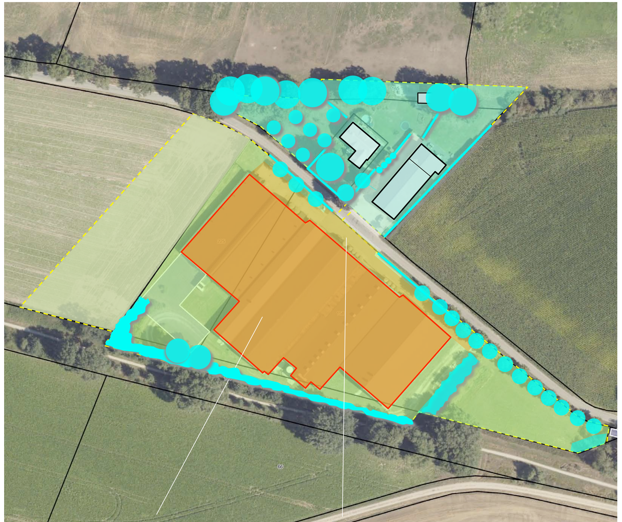
te slopen stallen en te verwijderen verhardingen
