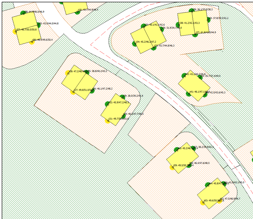
Figuur 4.9: detailweergave geluidbelasting ten gevolge van de N271 ter plaatse van sector A (incl. aftrek van 2 dB)
