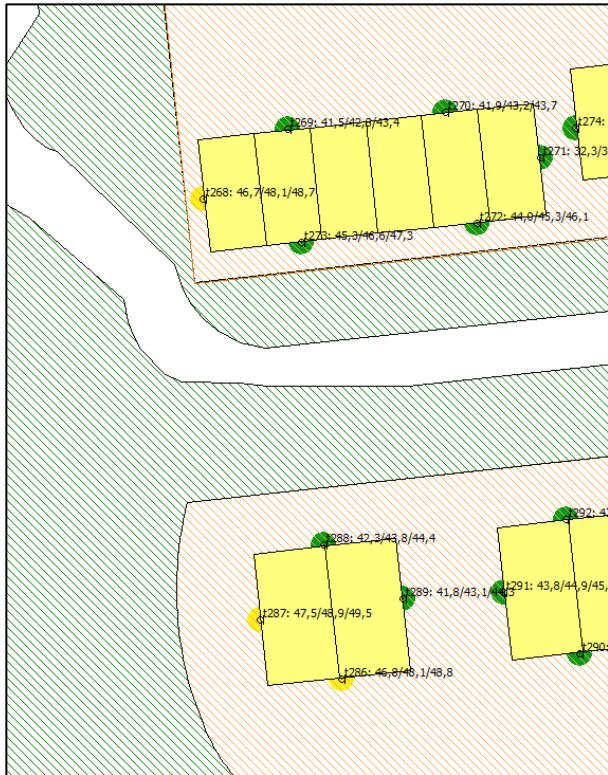
Figuur 4.12: detailweergave geluidbelasting ten gevolge van de N271 ter plaatse van sector C (incl. aftrek van 2 dB)
