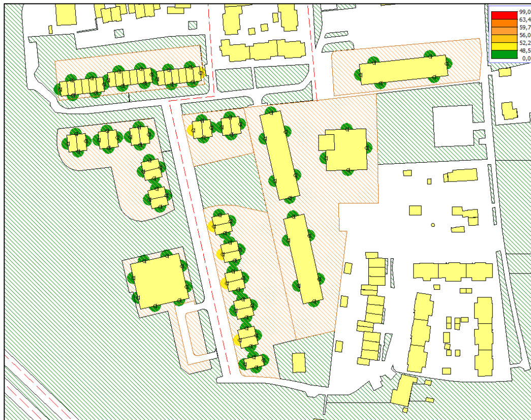
Figuur 4.5: geluidbelasting ten gevolge van de binnenplanse wegen ter plaatse van sector C (incl. aftrek van 5 dB)
