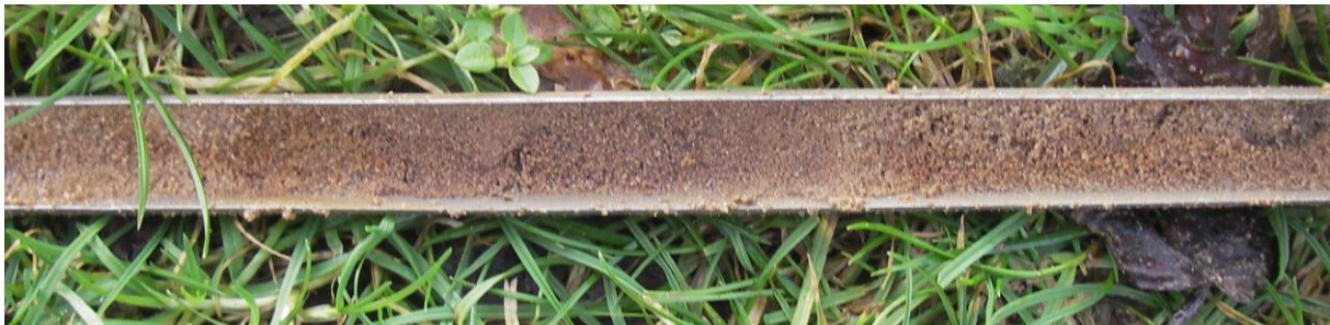
Figuur 18: De in boring 26 aangetroffen pakket humushoudend zand (midden). Dit zand komt overeen met het humushoudende zand zoals dat in de boringen 5 en 37 is aangetroffen.
