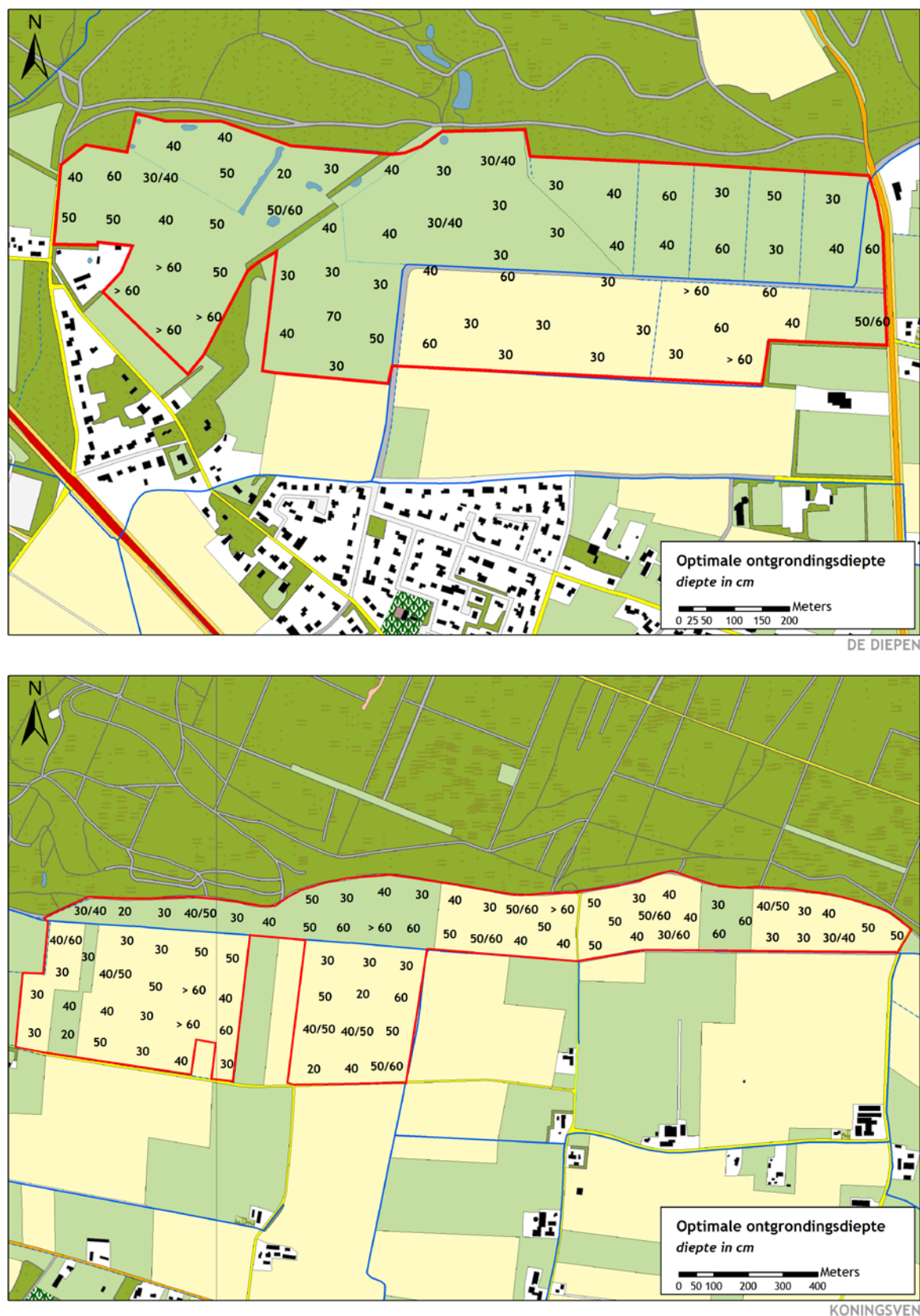
Figuur 23. Optimale ontgrondingsdiepte (in cm) per locatie in deelgebied De Diepen (boven) en het Koningsven (onder). Wanneer 2 diepten zijn aangegeven dan zal na afgraven van de geringste diepte een suboptimale situatie ontstaan en na afgraven van de grootste diepte een optimale situatie. Ondergrond: Topografische Dienst Kadaster, Emmen.
