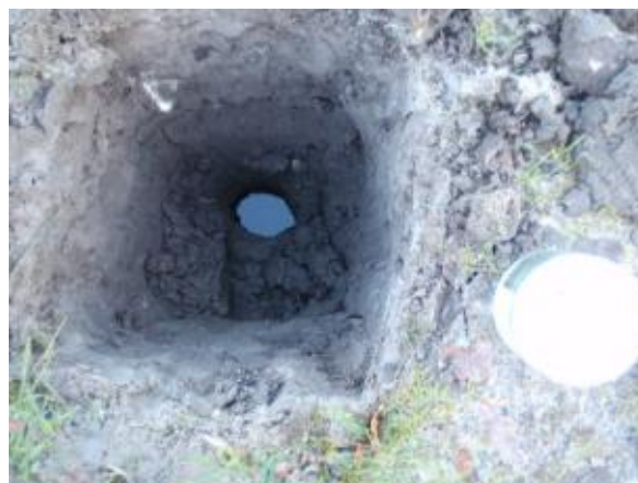
Foto 10: proefgat 02 met daarop te zien de grondwaterstand.
