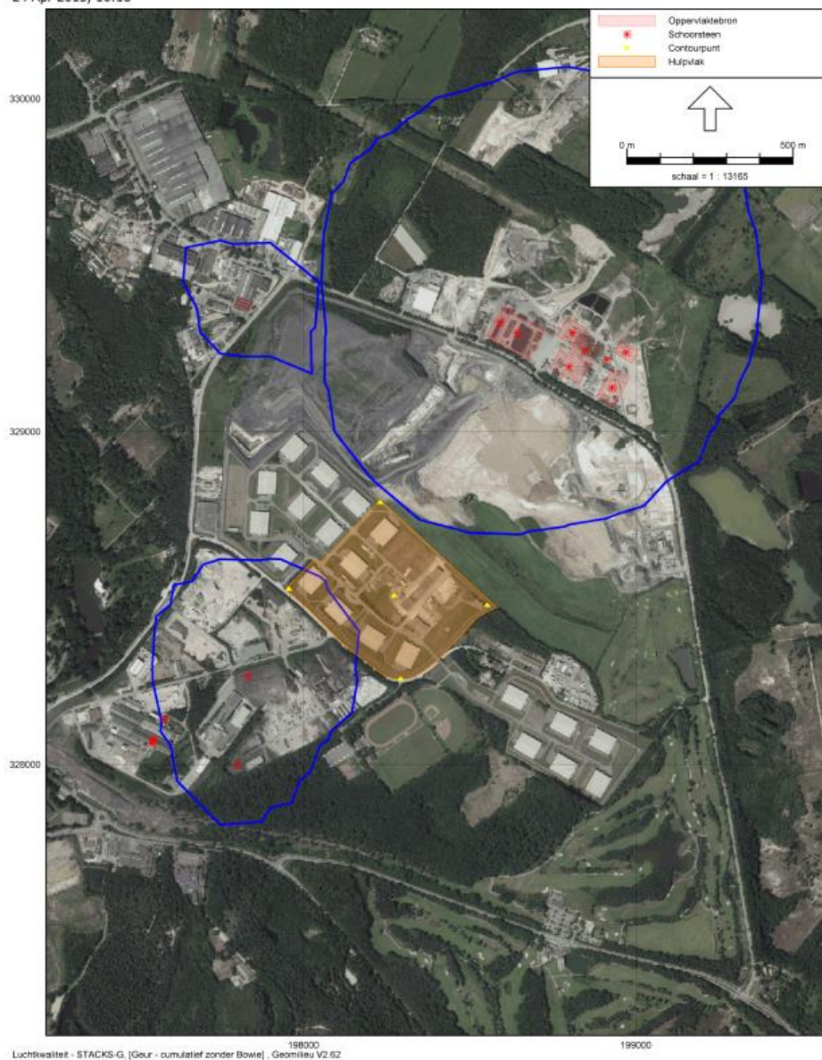
Figuur k: Contour van 2,1 ou E /m 3 als 98-percentielwaarde als gevolg van Vossenberg Kranenpool en Boschstraat, NV Afvalzorg en Wienerberger Poriso.
