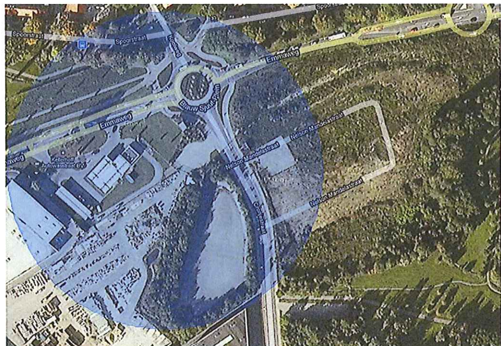
Figuur 3-2 Indicatie 10^{-6} plaatsgebonden risicocontour van het LPG tankstation
