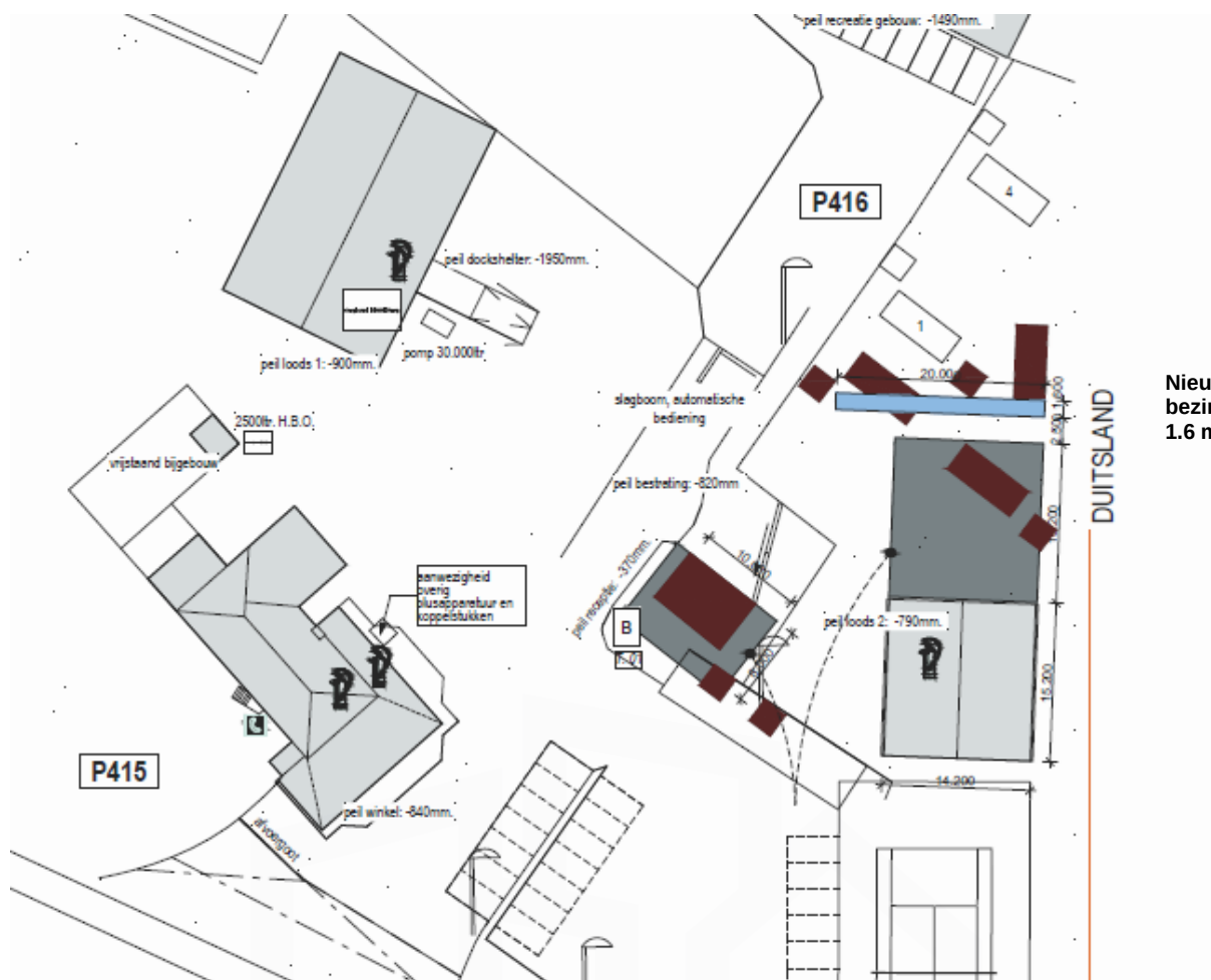
Afbeelding XVI : Situatietekening met nieuwe bezinkingsssloot
