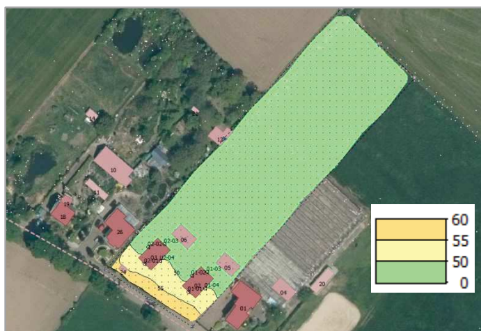
Figuur 4. Cumulatieve geluidbelasting (dB) (excl art 110g Wgh) op 1,5 meter hoogte
