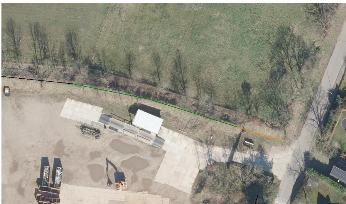
Figuur 5-1 Uitbreiding (oranje) en verhoging (groen) geluidwal
