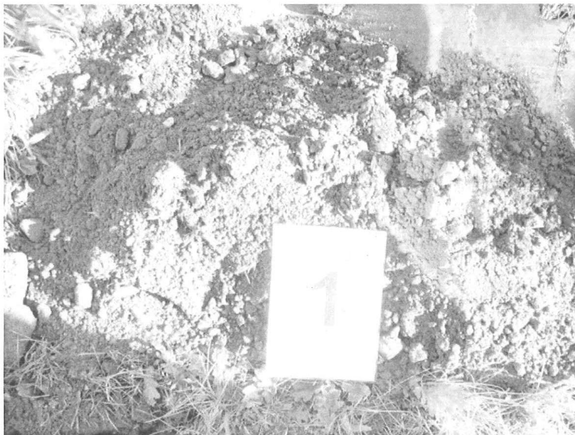
foto 3: uitkomend materiaal inspectiegat 1
