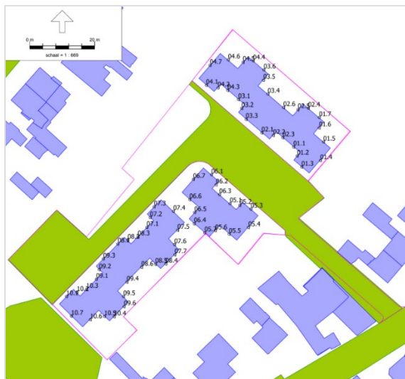
Figuur 8 Definitief plan, rekenpunten in het Geomilieu-model geluid door industrierrein
