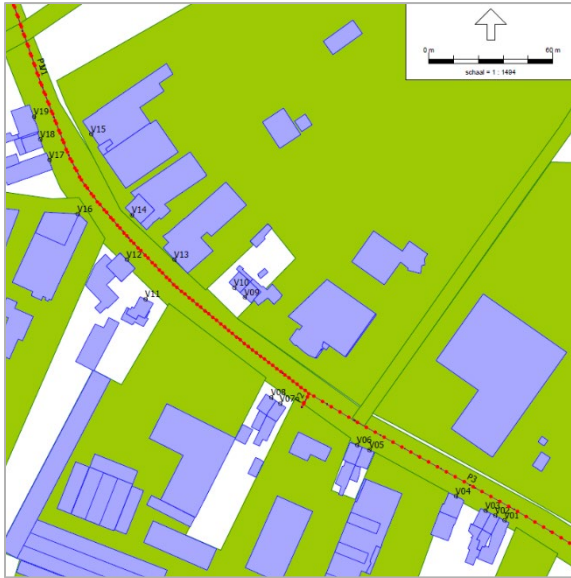
Figuur 20 Modellering geluidbronnen en rekenpunten voor het geluid vanwege de verkeersaantrekkende werking
