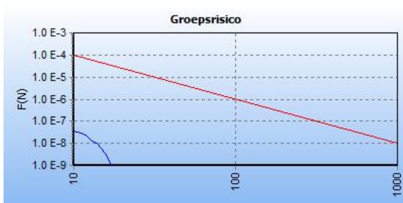
5.5 Figuur 5.5 FN curve voor 5660_leiding-A-534-deel-1 van N.V. Nederlandse Gasunie voor de kilometer tussen stationing 0.00 en stationing 1000.00
