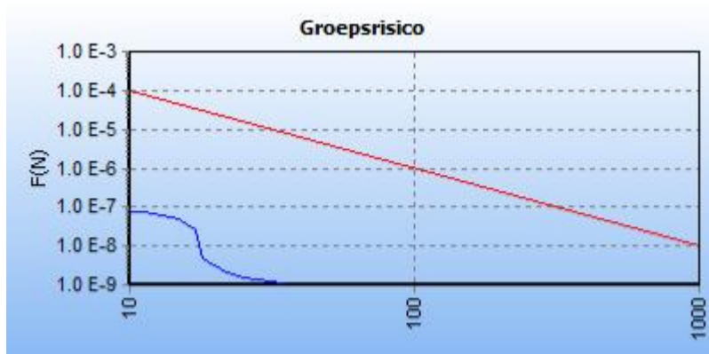
5.7 Figuur 5.7 FN curve voor 5660_leiding-A-630-deel-1 van N.V. Nederlandse Gasunie voor de kilometer tussen stationing 1300.00 en stationing 2300.00
