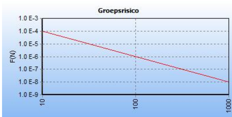
5.11 Figuur 5.11 FN curve voor 5660_leiding-Z-503-02-deel-1 van N.V. Nederlandse Gasunie voor de kilometer tussen stationing 0.00 en stationing 130.00
