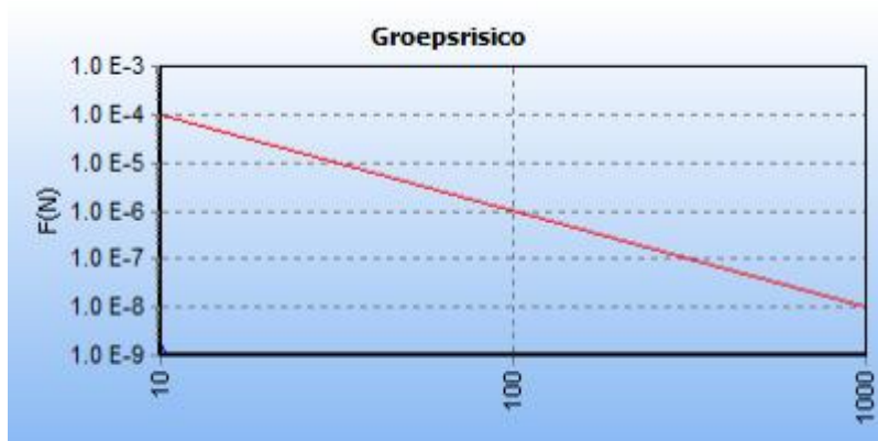
5.8 Figuur 5.8 FN curve voor 5660_leiding-A-645-deel-1 van N.V. Nederlandse Gasunie voor de kilometer tussen stationing 0.00 en stationing 1000.00
