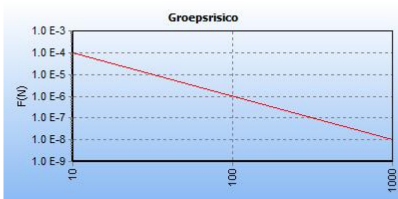
5.13 Figuur 5.13 FN curve voor 5660_leiding-Z-503-23-deel-1 van N.V. Nederlandse Gasunie voor de kilometer tussen stationing 0.00 en stationing 120.00
