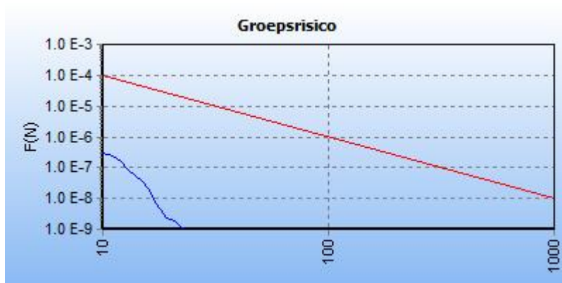
5.8 Figuur 5.8 FN curve voor 5660_leiding-A-645-deel-1 van N.V. Nederlandse Gasunie voor de kilometer tussen stationing 0.00 en stationing 1000.00
