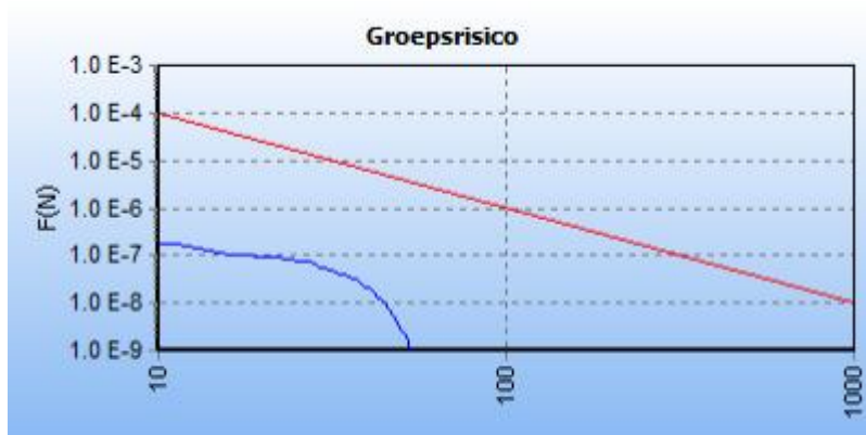
5.11 Figuur 5.11 FN curve voor 5660_leiding-Z-503-02-deel-1 van N.V. Nederlandse Gasunie voor de kilometer tussen stationing 0.00 en stationing 130.00
