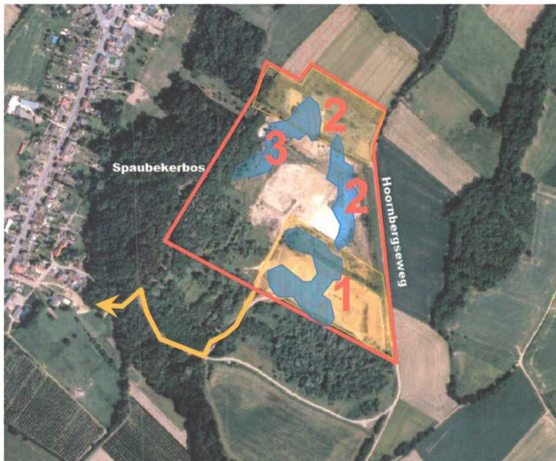
Figuur 1.2 Indicatieve weergave van de fasering van de werkzaamheden in Groeve Spaubeek. Ter plaatse van de oranje locaties zal grondstoffenwinning plaats vinden. Ondiepe plassen worden aangelegd ter plaatse van de blauw gemarkeerde locaties. De grondstoffen worden afgevoerd over de onverharde transportweg ter plaatse van de oranje pijl.
