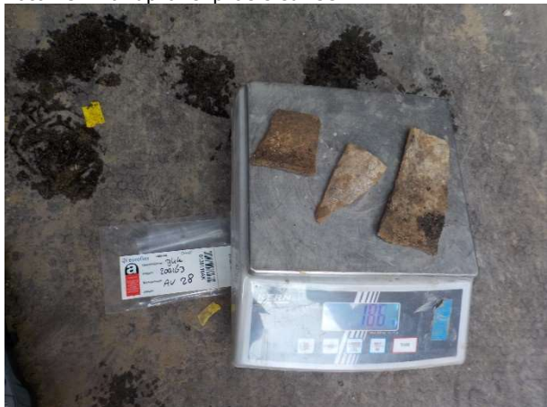
Foto 15. Aangetroffen asbest in proefsleuf 28
