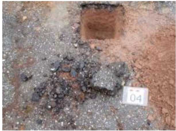
Foto 20: Boring 4 met baksteen onder asfalt op voorterrein langs de Looiwinkelstraat.
