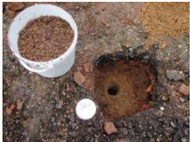
Foto 22: Boring 34. Ter plaatse van voormalige droogoven wordt asfalt op baksteen aangetroffen.
