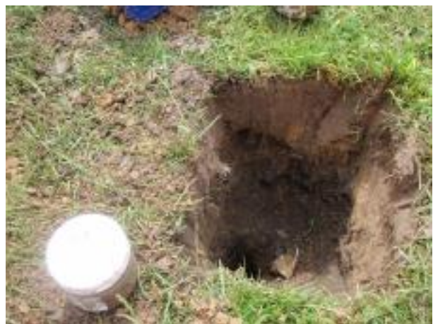
Foto 24: In boring 53 is onder de bovengrond een laag baksteen en leisteen aangetroffen. Zie boorprofielen in bijlage IV.
