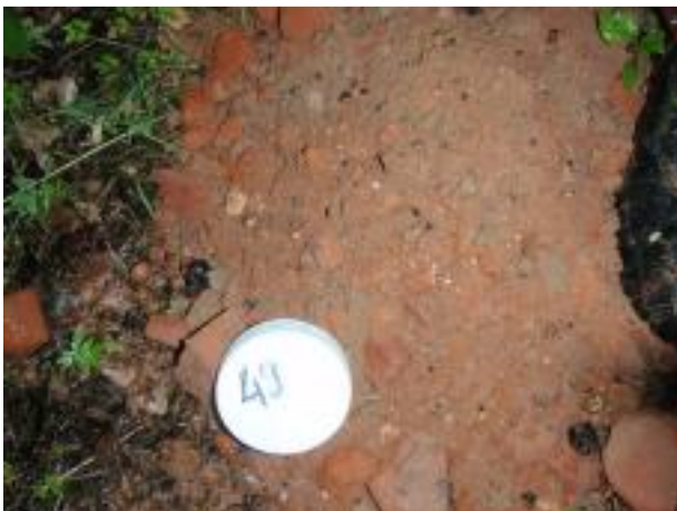
Foto 21: Boring 49. Ter plaatse van nieuwbouw is 30 cm baksteen onder asfalt aanwezig.
