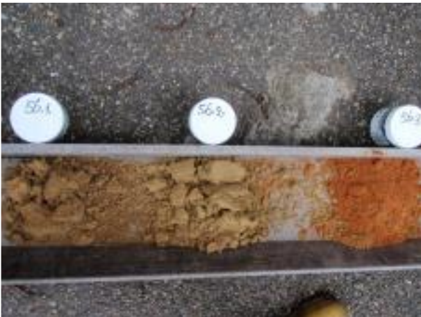
Foto 15: Boring 56. Baksteenlaag op 1 m-mv. Zie boorprofielen in bijlage IV.
