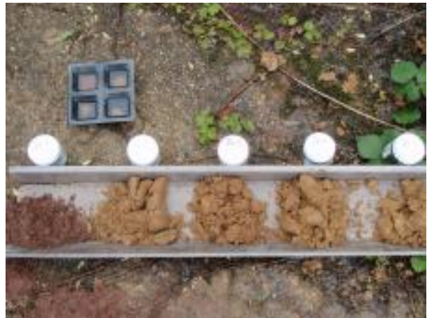
Foto 16: Boring 70 bij voormalige HBO-tank. Let op kleiige leem. In bakjes wordt olie/water-reactie getest.
