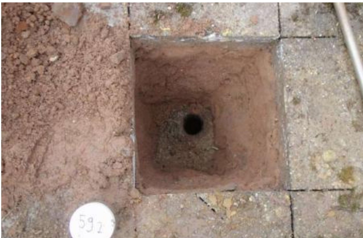
Foto monsternamen met fundering van baksteen onder gezaagd asfalt (boring 59) (Bron: "Verkennd bodemonderzoek Looiwinkelstraat te Spaubeek", BKK Bodemadvies, juli 2013)
