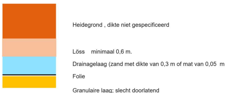
Figuur 10: Schematische opbouw van de afdeklaag
