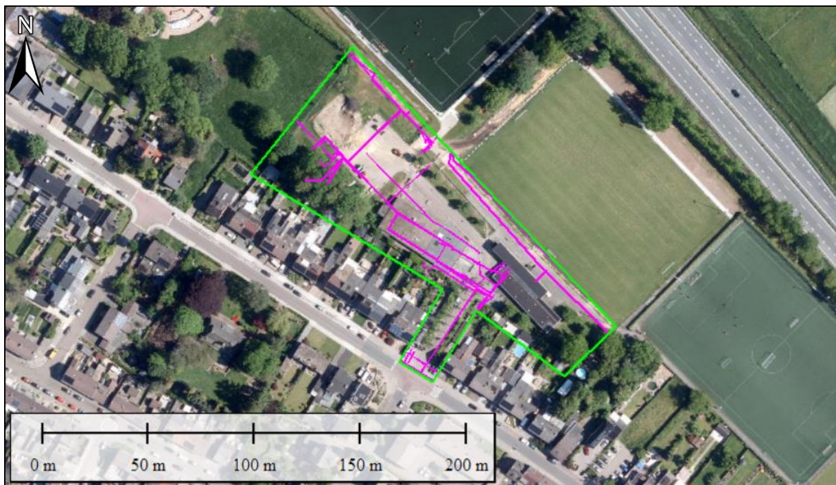
Figuur 62. Overzicht van de als gevolg van de aanleg van kabel- en leidingentracés geroerde gronden. Bron: kadaster; bron satellietbeeld: World imagery.
