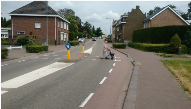
Oversteekvoorziening met middengeleider: zonder VOP (links) en met VOP en blauw witte koker (rechts)
