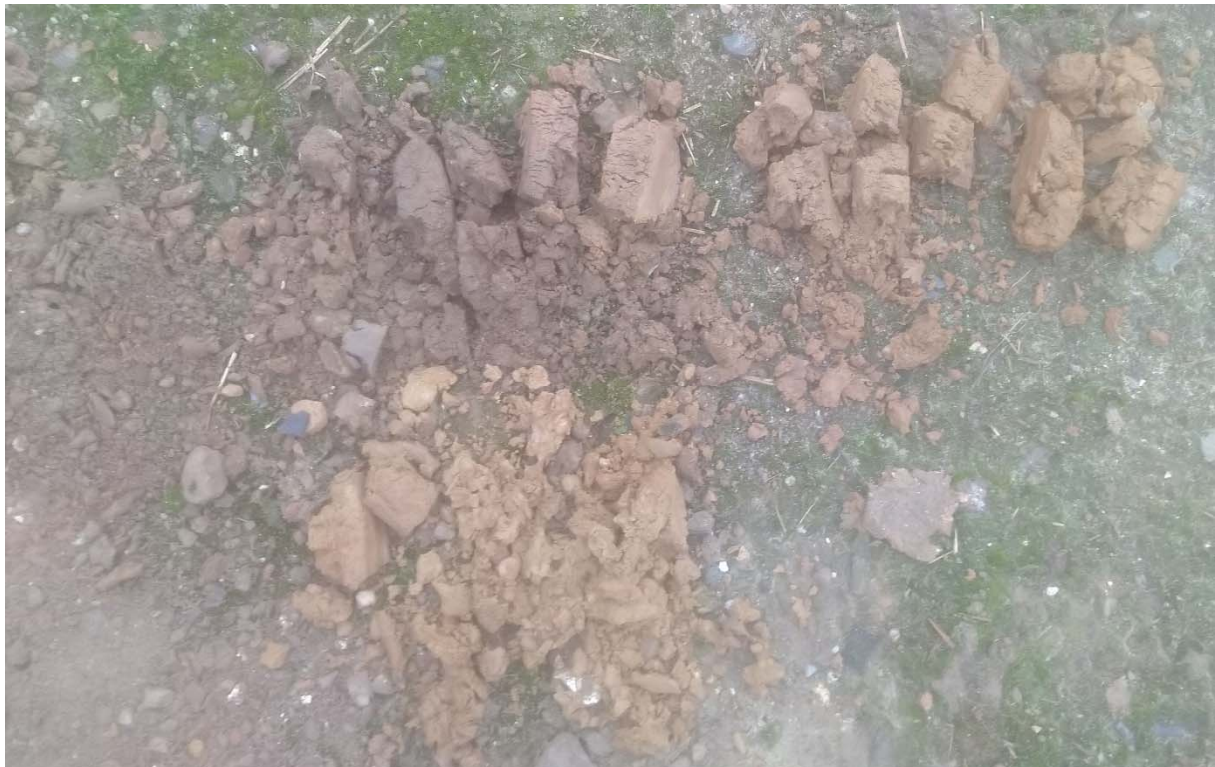
Afbeelding 13: Boorresidu van boring 3. Bovenste laag: 30-100 cm -mv, onderste laag: 100-170 cm -mv. Bron: fotoarchief Geonius
