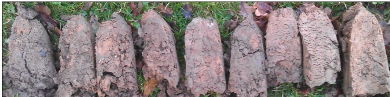
Figuur 2: boring 11 met tot 90 centimeter een geroerd pakket
