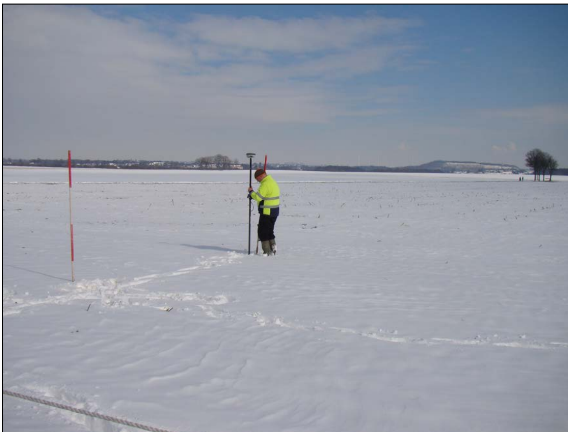
Afbeelding 8. Fotografische weergave van het uitzetten van de proefsleuven met behulp van de GPS Rover (GRX1). Fotograaf: L. R. van Wilgen.
