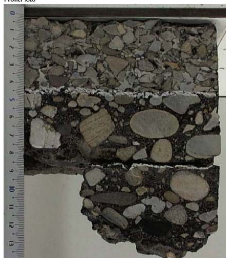
Figuur 6: Asfaltkern A3
