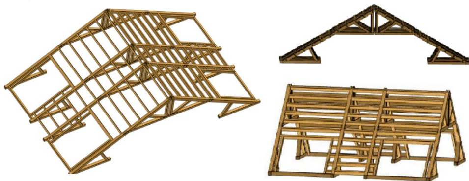
Traditioneel uitgevoerde kapconstructie van appartementengebouw "Visser".
