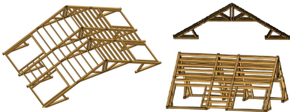
Traditioneel uitgevoerde kapconstructie van appartementengebouw "Visser".
