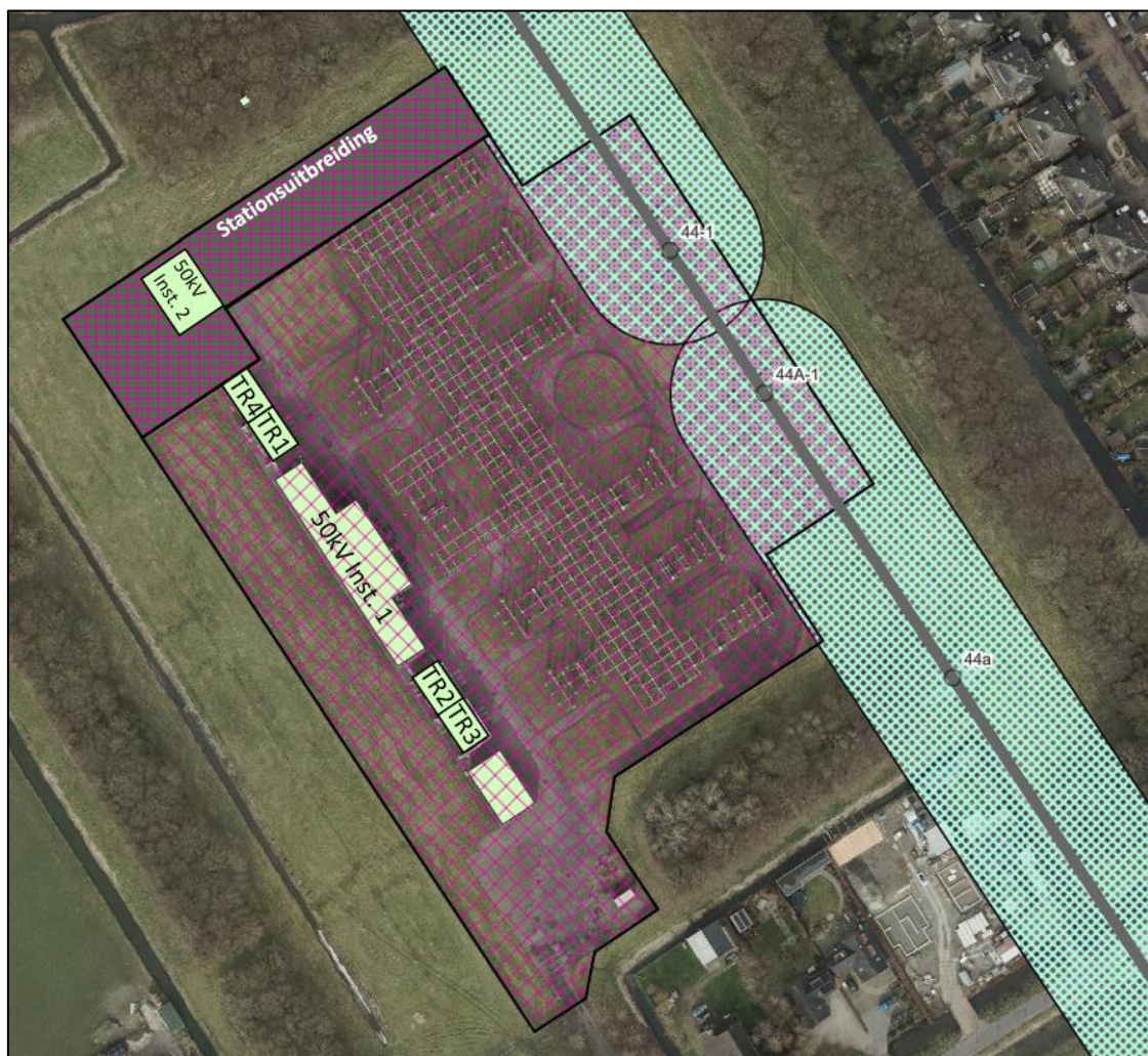
Figuur 1: Lay-out stationsontwerp eindsituatie OS Wijdewormer (bron: Qirion geodiensten, met hieraan toegevoegd de stationsuitbreiding).
