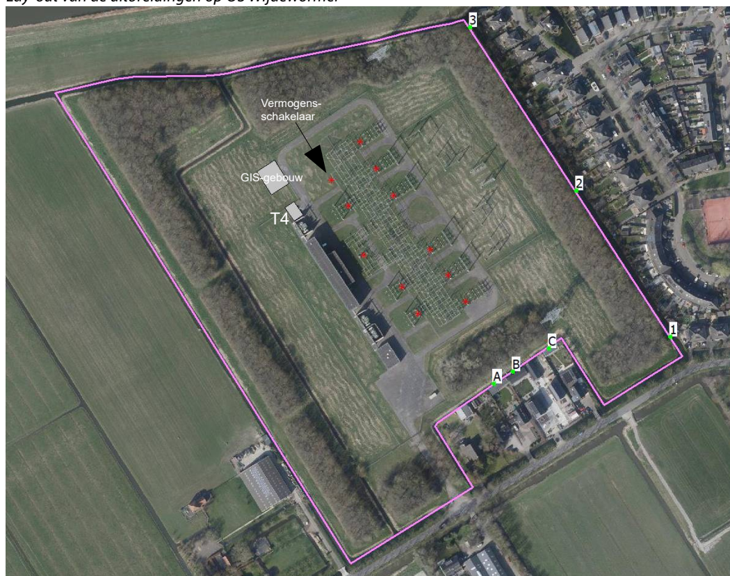
f2.2 Lay-out van de uitbreidingen op OS Wijdewormer
