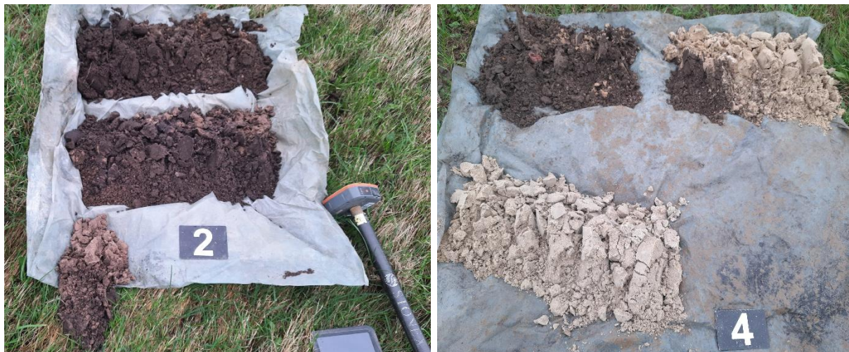
Afbeelding 4: Foto profiel infiltratieboringen 2 en 4: Uitgelegd per halve meter vanaf maaiveld (linksboven) tot einddiepte (rechtsonder)
