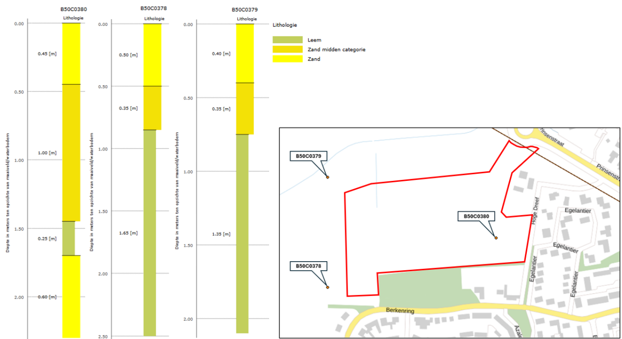
Figuur 2-5: Locaties en boormonsterprofielen van grondboringen B50C0380, B50C0378 en B50C0379 (bron: DINOluket).
