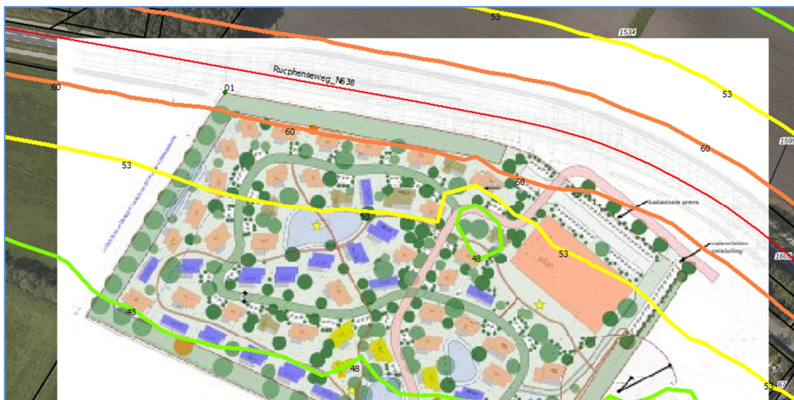
Afbeelding 3 Berekende geluidcontouren N638 (exclusief correctie art. 110g Wgh)
