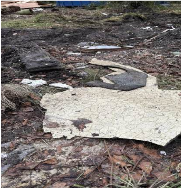
Foto 105 zeil asbestvrij, zwart vilt onderzijde, terrein A
