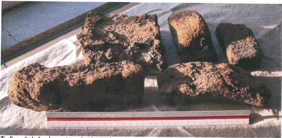
Turfjes uit de fundament van het kasteel van Breda: bouwfraude door De Wyse, 1684 - 1698.
