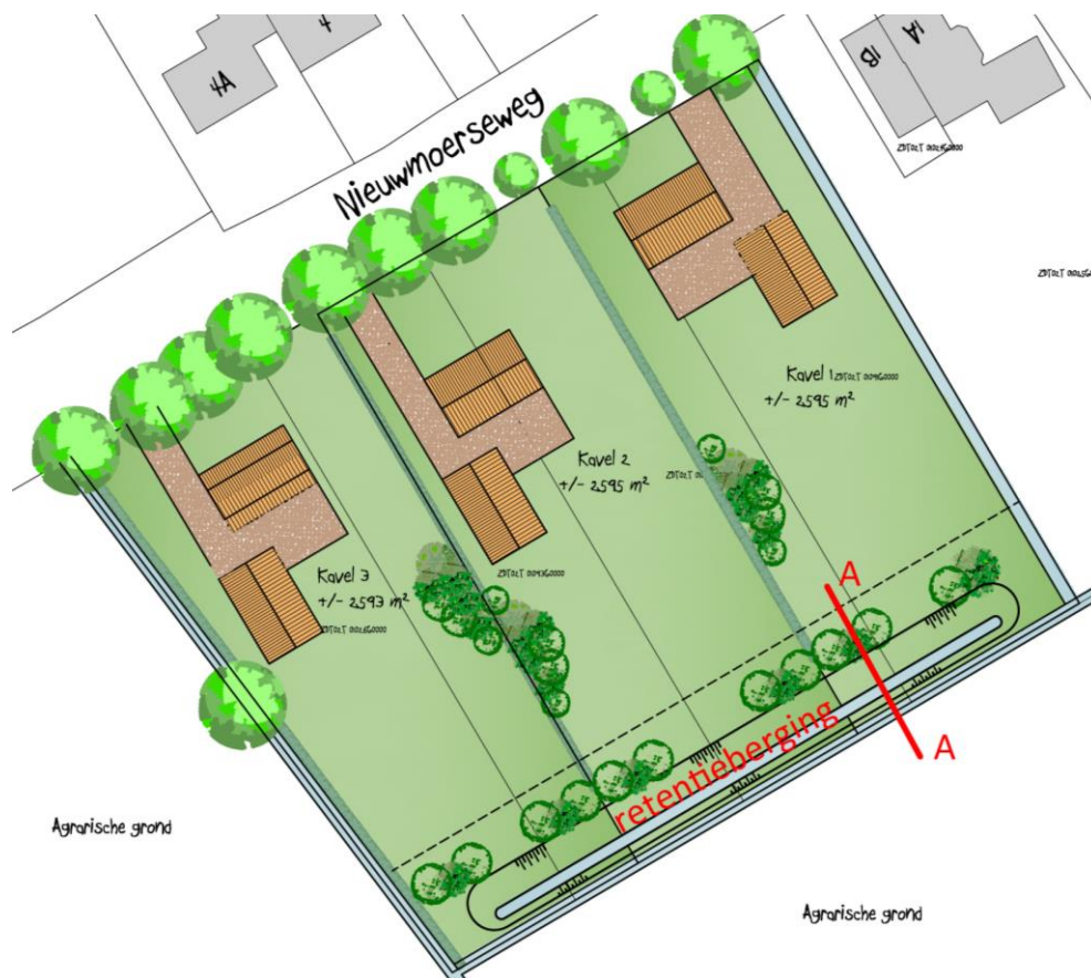
Figuur 19: overzicht retentieberging
