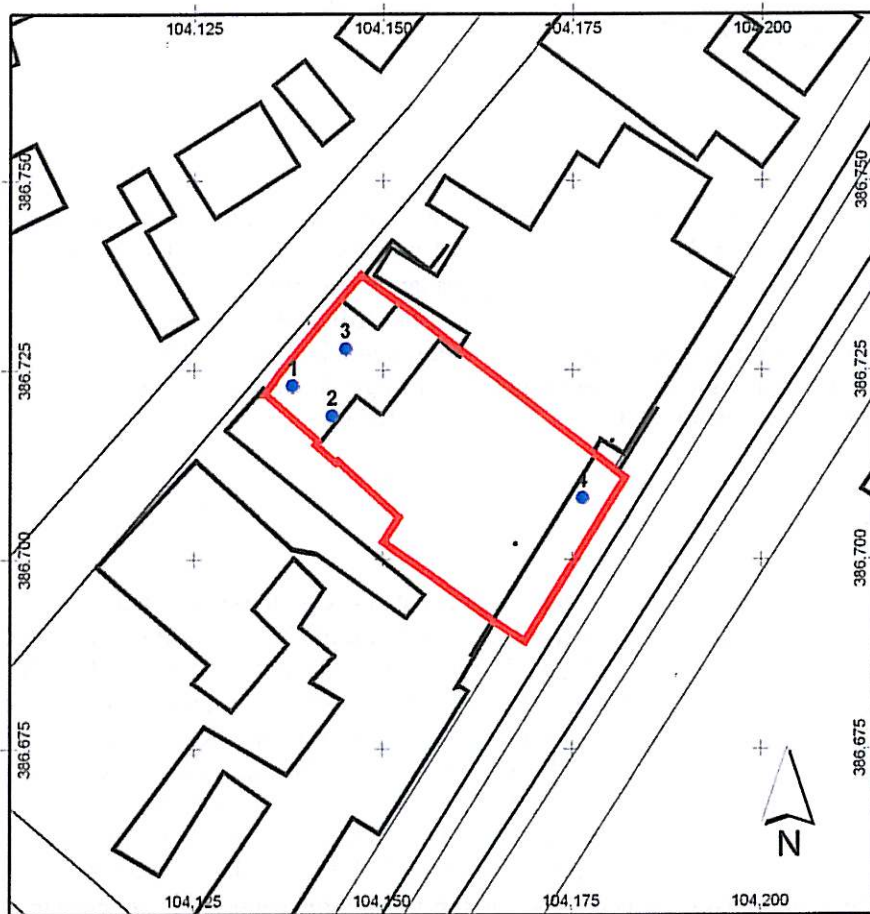
Afbeelding 10. De positie van de boorpunten van het IVO (genummerd en blauw gemarkeerd), geprojecteerd op een uitsnede van de Kadastrale kaart van het onderzoeksgebied. Schaal 1: 1.000. ©Topografische Dienst, Emmen [2008].
