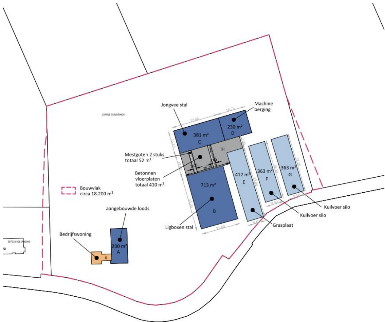
Figuur 5: Overzicht bestaande situatie Krochtenweg 6
