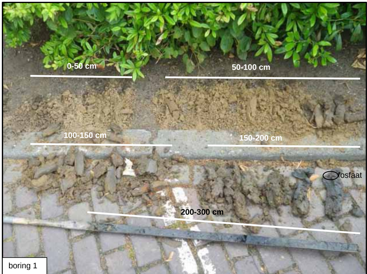
Figuur 4: De bodemopbouw van boring 1, met onder andere de fosfaatvlekken op de (donker)grijze rivierafzettingen.
