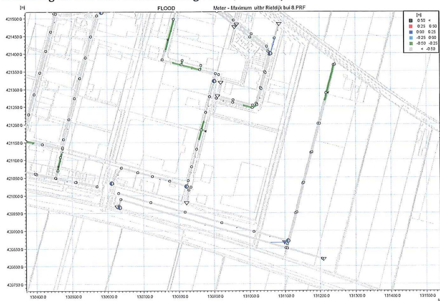
Afbeelding II.a Overzicht rioolberekening VRWA / SRWA bij bui 8
