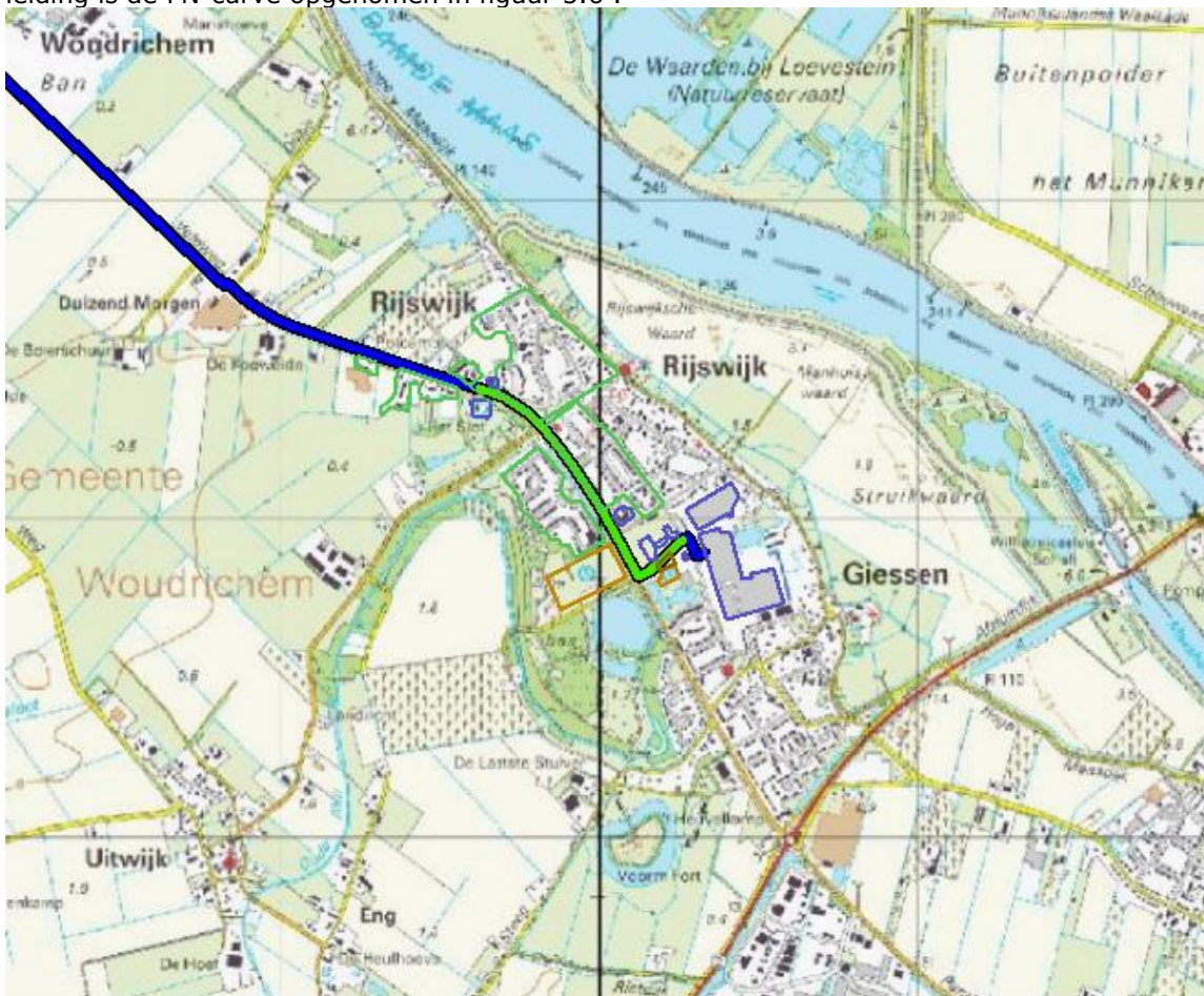
Figuur 5.5 Kilometer leiding behorende bij de maximale overschrijding exclusief ontwikkeling van de FN-curve voor Z-543-01 van N.V. Nederlandse Gasunie
