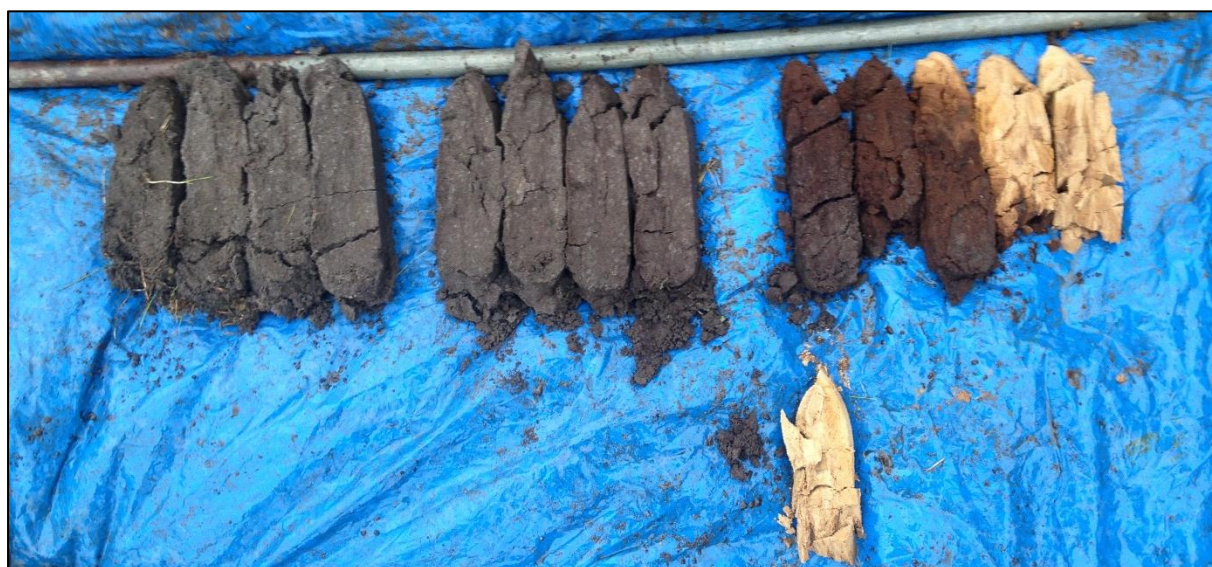
Boring 2: 0-160 cm -Mv. Bovenste rij boorkernen 0-150 cm -Mv. Onderste boorkern 150-160 cm -Mv.
