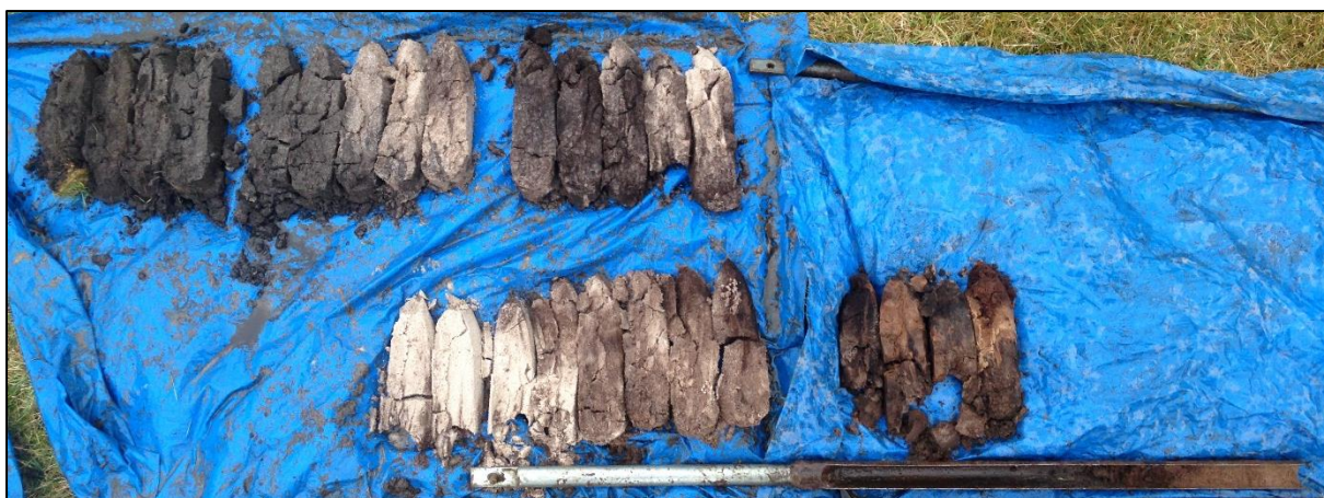
Boring 4: 0-270 cm -Mv. Bovenste rij boorkernen 0-150 cm -Mv. Onderste rij boorkernen 150-240 cm -Mv. Steekguts 240-270 cm -Mv.
