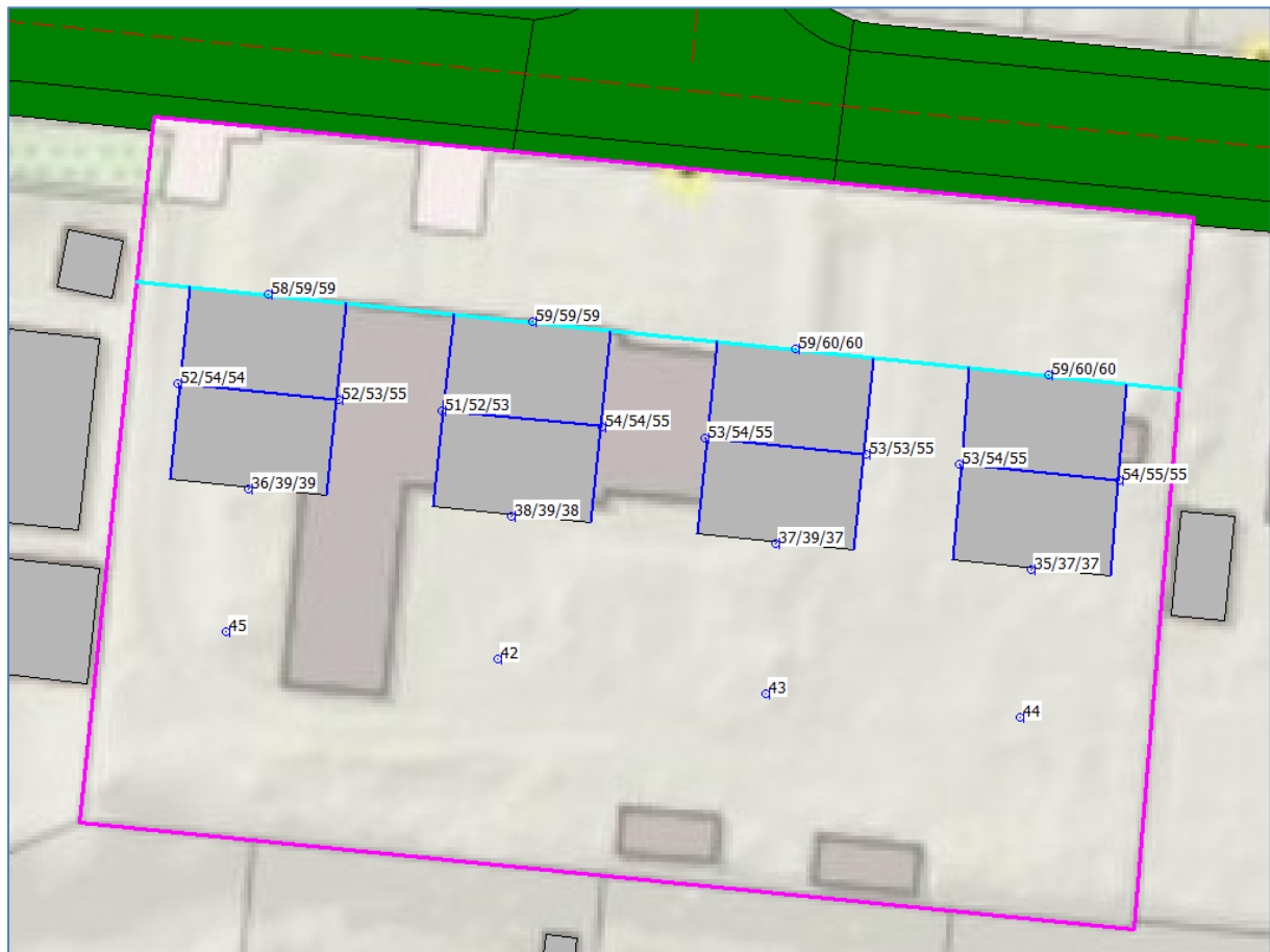
Afbeelding 5. Geluidbelastingen Lden (excl. aftrek art. 110g Wgh) cumulatief Berekende geluidbelastingen op een hoogte van 1,5 / 4,5 / 7,5 meter
