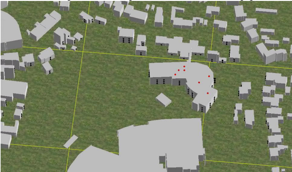
Figuur 3-1 Een 3D-weergave met in rood de geluidbronnen en in zwart de toetspunten
