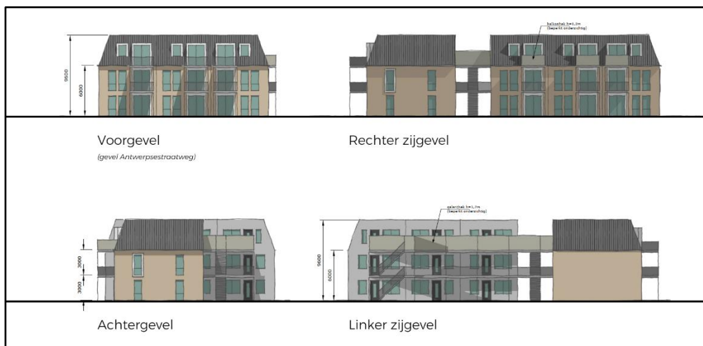
Gevelbeelden appartementen. Bron: Kort Geytenbeek Architecten, 2022.
