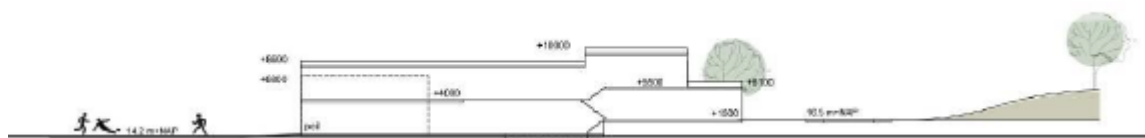
Figuur 2.4: Doorsnede bouwmassa met gebruik van split-level
