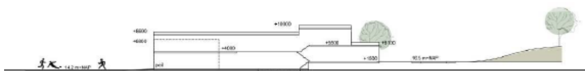
Figuur 2.4: Doorsnede bouwmassa met gebruik van split-level
